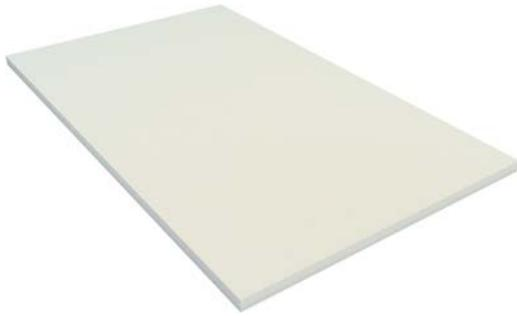
Pannello in cartongesso da 2,4 m<sup>2</sup> di superficie e 45 mm di spessore per la realizzazione di un impianto di riscaldamento e raffrescamento a controsoffitto radiante della serie GKCS. Il pannello è di tipo inattivo; non è dotato di circuiti idraulici e serve al completamento della superficie attiva realizzata con i pannelli attivi KS60 e KS120. Il pannello è costituito da una lastra in cartongesso da 15 mm e uno strato di isolamento termico da 30 mm in EPS.
