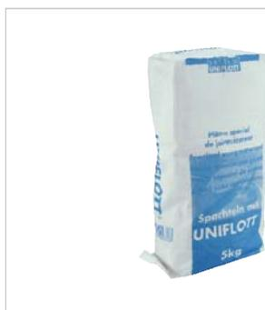
Stucco per la finitura dei giunti. Composto in polvere a base di gesso con additivi sintetici per applicazioni speciali, pronto per l'uso. Le stuccature dei giunti devono essere preventivamente armate con nastro in rete KGNAS.
