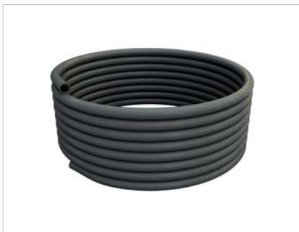
Tubo in polibutilene con barriera antiossigeno per collegamento in serie fra pannelli attivi in combinazione con raccordi rapidi RC. Il terminale del tratto di tubo deve essere necessariamente completato con la bussola di rinforzo RC900 prima dell'inserimento nel raccordo rapido RC.
